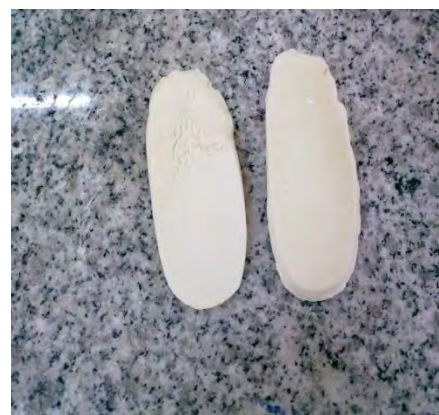
Figure 12 : La matière gommeuse séparée après centrifugation
