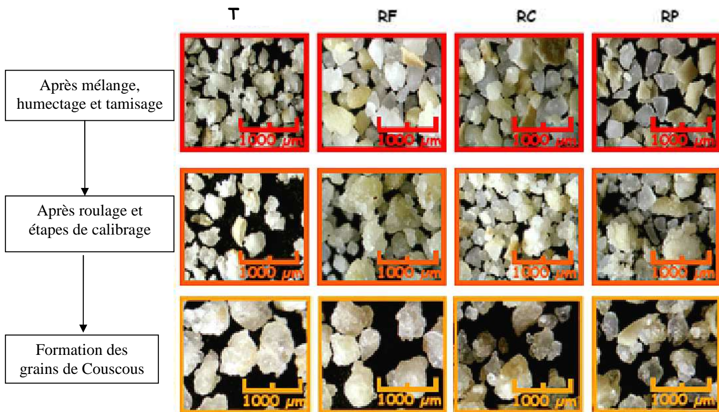
Figure 20. Opérations de roulage le long des principales étapes du diagramme de fabrication des couscous. T : Témoin, RF : Riz-Fèverole, RC : Riz-pois Chiche, RP : Riz-Pois protéagineux
