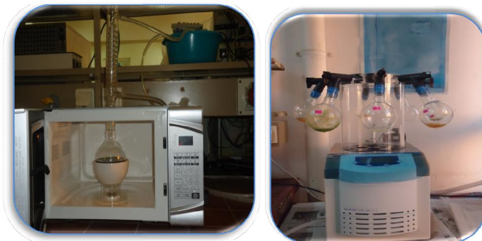
**Photographie 8:** Extraction par micro-ondes (à gauche) et le lyophilisateur utilisé (à droite)
