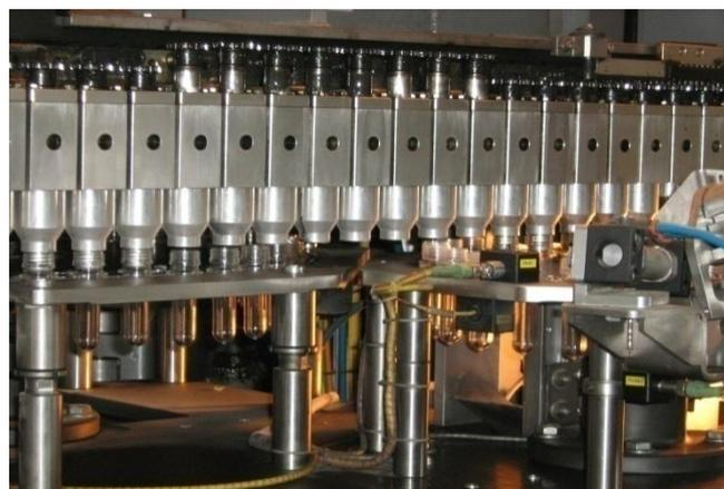
Figure 1. Image de la souffleuse de la préforme
