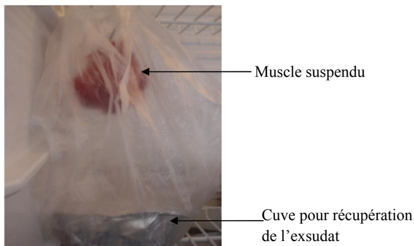
**Figure 28.** Mesure de la perte de poids et en exsudat du muscle lors de la réfrigération.
