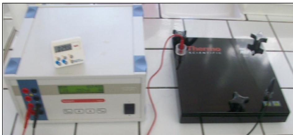
**Figure 26.** Appareil d'électrotransfert utilisé pour le western blot.
