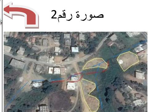
يمكننا حساب المساحة المعرضة للفيضانات في حوض المجرى المائي الصغيرة التي تعترضها الحواجز، و هذا بعد حساب صبيب المياه débit باستعمال الطريقة التقليدية méthode rationnelle و باعتبار أن الأرضية الموجودة خلف الحواجز مستوية طبوغرافيا و ضيقة بصفة لا تسمح بانتشار واسع للمياه و نسبة تسرب منعدمة و أن شدة الأمطار تساوي  $24\text{mm/h}$ .
