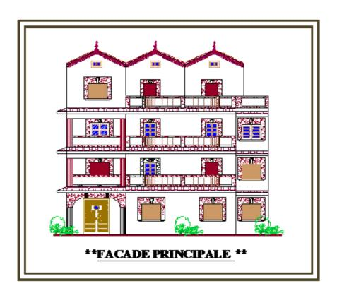
Figure 38: un traitement important des baies et une toiture en charpente
