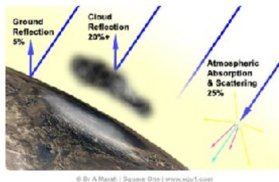
Figure 3- 12 : Effets de l'atmosphère sur l'irradiation solaire
