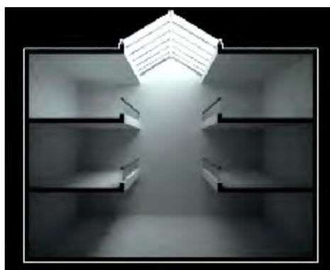
Pour cela, la partie opaque supérieure de ces systèmes doit avoir un facteur de réflexion élevé pour permettre, en particulier pour les étages inférieurs, une pénétration importante de la lumière. Mais ceci peut conduire à créer des protections contre l'éblouissement dans les parties hautes. De même, l'inclinaison des murs du puit de jour (par exemple de  $10^\circ$ ) permet également un accroissement important de la lumière, car la composante directe augmente.<sup>28</sup>
