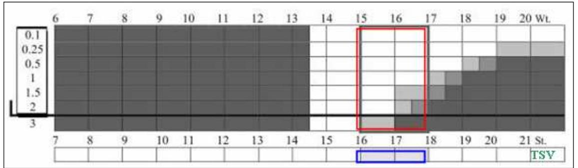
**Fig. C-8 :** Ensoleillement des façades Nord-Ouest avec différents ratios d'H/W
