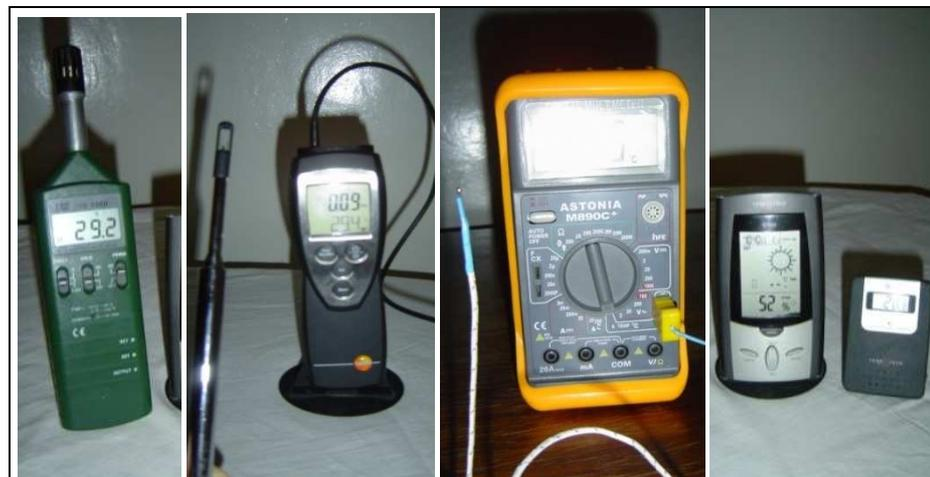
**Thermo-hygromètre    Anémomètre    Multimètre    Centrale météo**
