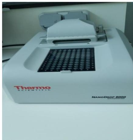
**Photographie N°1:** Spectrophotomètre NanoDrop8000
