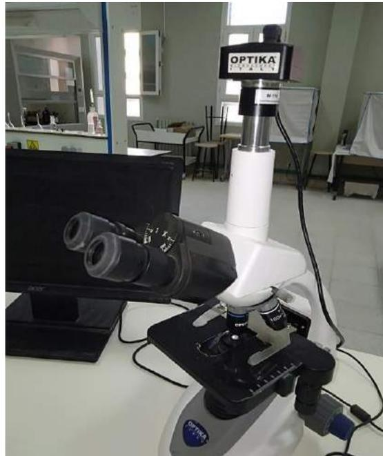
صورة (2-2) جهاز التصوير المستعمل m-144 - Optika Microscopes
