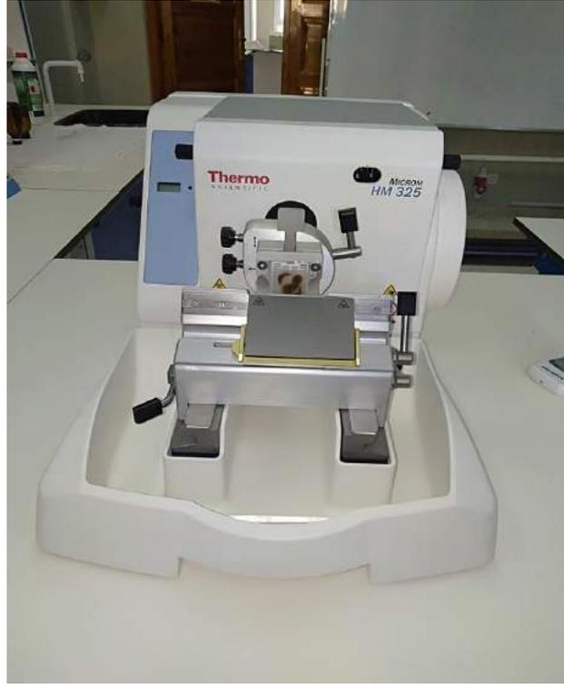
صورة (1-2) جهاز المشراح المستعمل Thermo / Microm HM 325 Rotary Microtome
