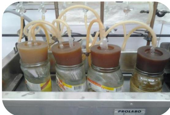
Figure 4: photo des milieux simplifiés dans le bain-marie sous flux de CO<sub>2</sub>
