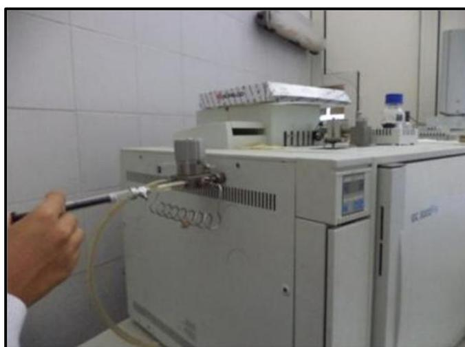
**Figure 23** : Injection du volume de gaz dans la CPG via une microseringue étanche au gaz
