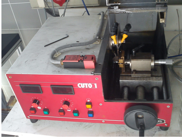
Figure II-4 : La micro-tronçonneuse de marque TREIFUS cuto1
