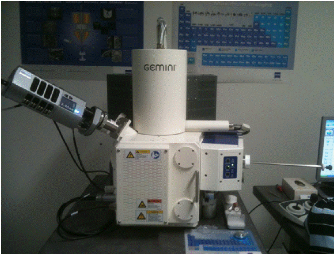
Figure II-19 : Microscope électronique à balayage à effet de champ (MEB-FEG) SUPRA 40.
