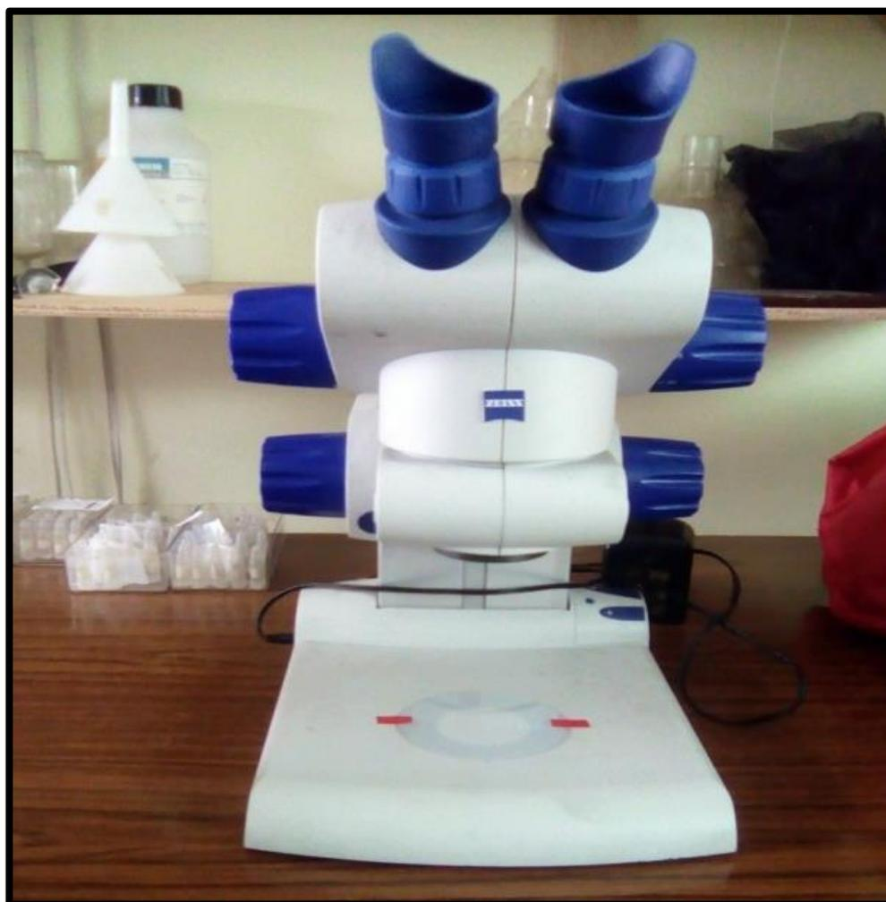
**Figure 41.** Loupe binoculaire De marque « Carl Zeiss » à grossissement X32 (Photo originale)
