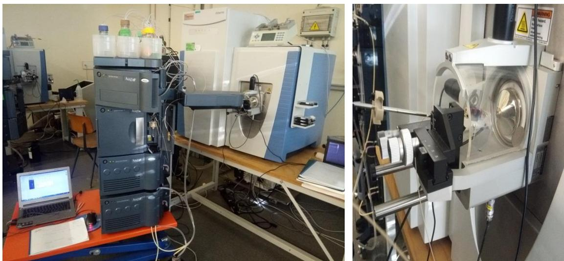
**Figure 46 :** (A) : Système UPLC couplé à la spectrométrie de masse, (B) source d'ionisation électrospray (ESI) (*Laboratoire de Spectrométrie de Masse (LSM), l'institut de Chimie, Université de Liège, Belgique*).
