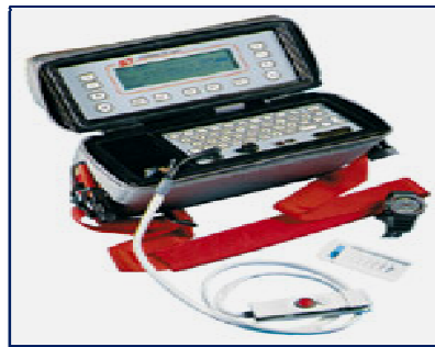
Figure.10. Poromètre à diffusion de vapeur type Delta Devices MK3 R .
