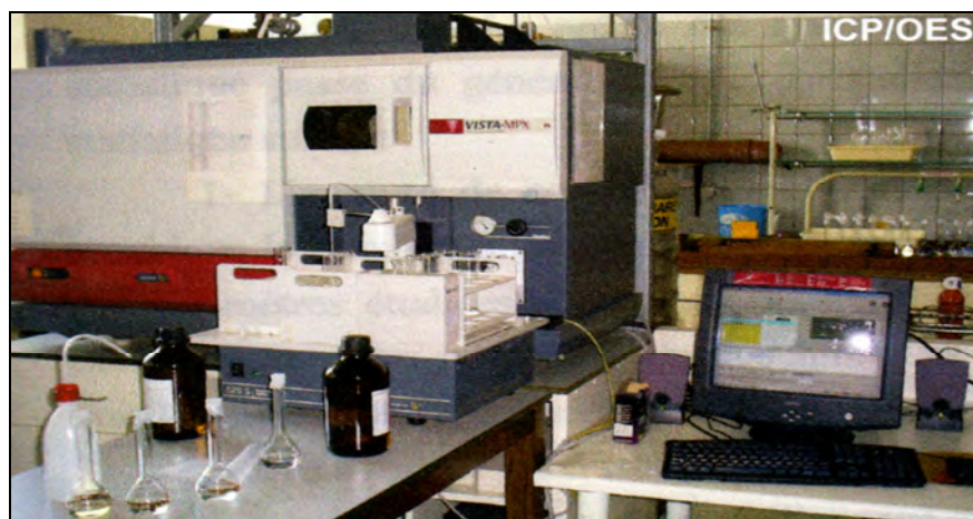
Figure 27. Appareil utilisé pour le dosage des éléments traces dans le sol et la végétation.
