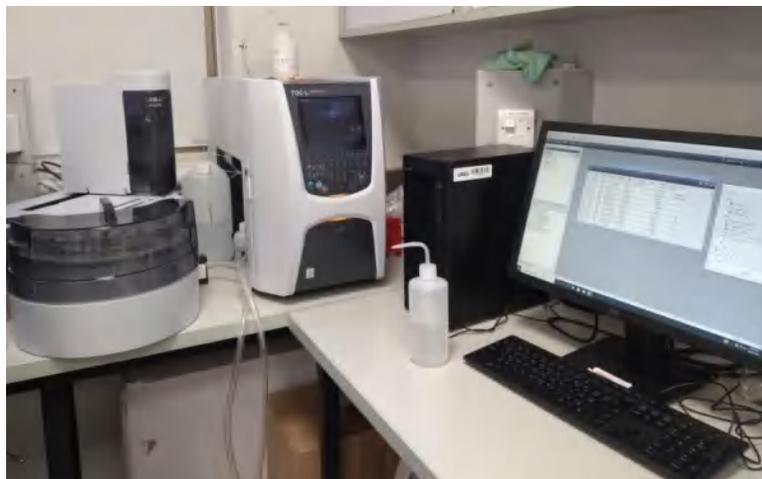
**Figure 24.** Analyseur de carbone organique totale (TOC-L).
