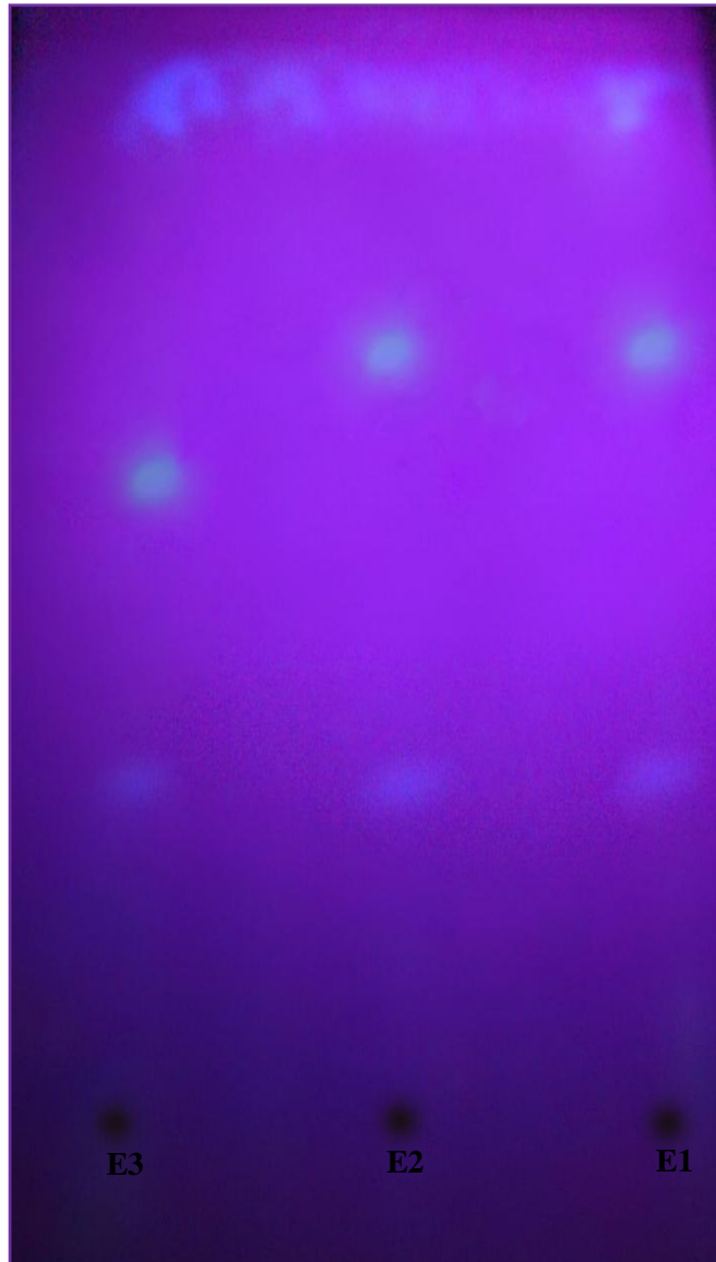
Figure 13: Chromatogramme (CCM) des échantillons de maïs sous lumière UV 365 nm: E Échantillon. Absence de STC selon le procédé.
