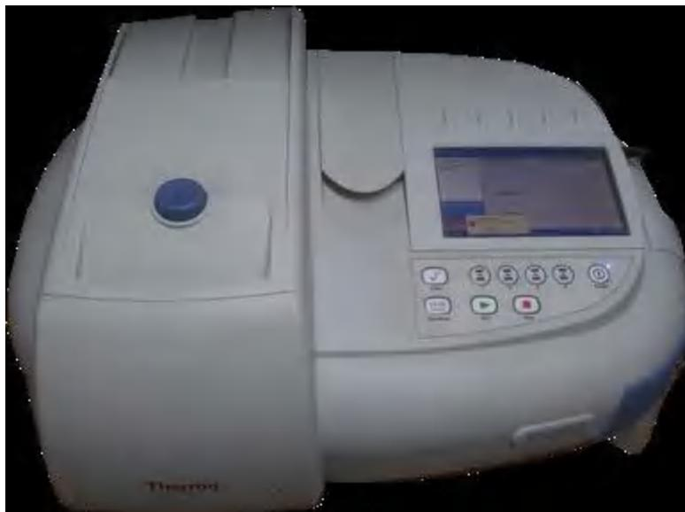
*Figure. II.12 : Spectrophotomètre UV-visible «Thermo scientific».*
