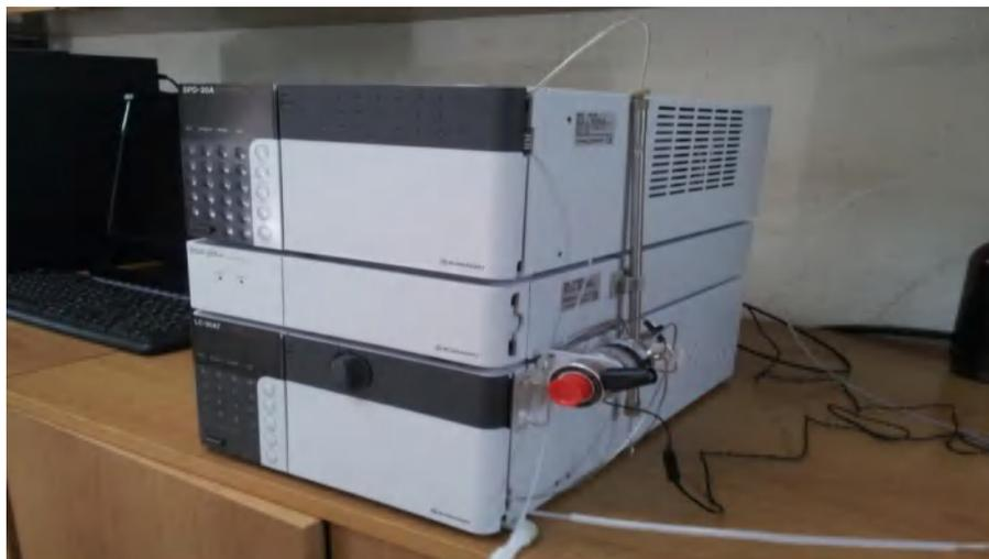
*Figure. II.13 : Chromatographie HPLC Shimadzu LC20 du laboratoire LSTE.*
