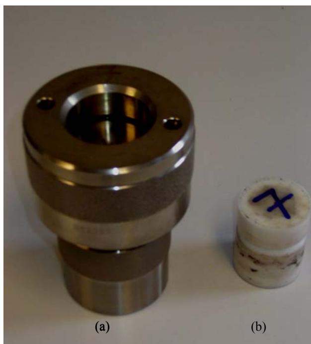
**Figure II.5** : Schéma d'une bombe Parr (a) et d'une nacelle de téflon (b).
