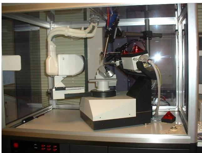
**Figure I-1** : *diffractomètre KAPPA CCD*
