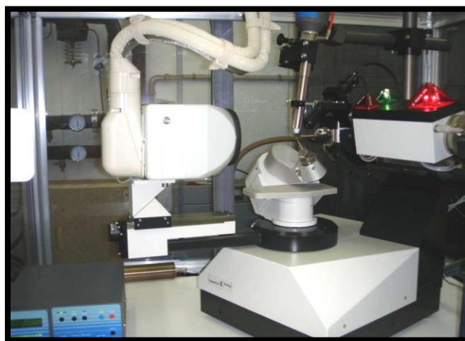
Figure 1. Diffractomètre à rayons X de géométrie Kappa CCD
