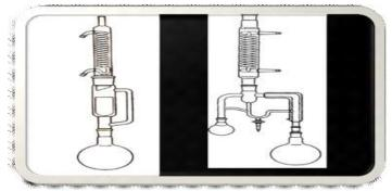
Figure 20 : Extracteur de Soxhlet et de Lichens-Nickerson (Source : Boutayeb, 2013]
