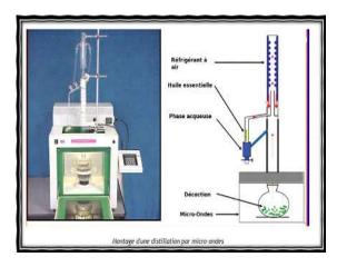
Figure 18 : Montage d'extraction assistée par micro-ondes.
