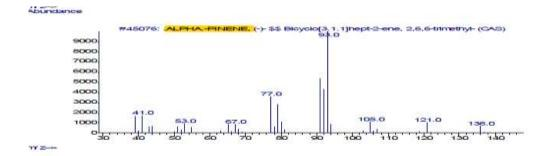
Figure 65 : Spectre de masse de l'α-pinène
