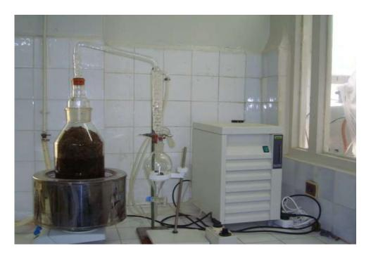
Figure 50 : Montage utilisé pour l'extraction des huiles essentielles
