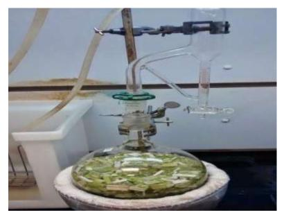
Figure 15 : Montage d'extraction de type Clevenger.
