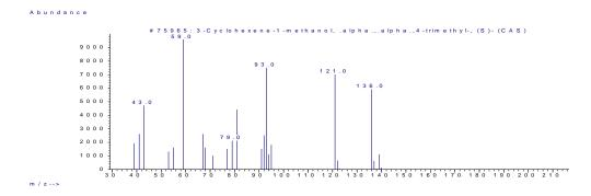
Figure 68 : Spectre de masse du α-terpinéol
