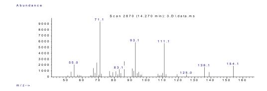
Figure 69 : Spectre de masse du 4-terpinéol
