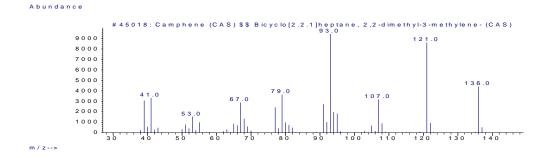
Figure 67 : spectre de masse du camphene
