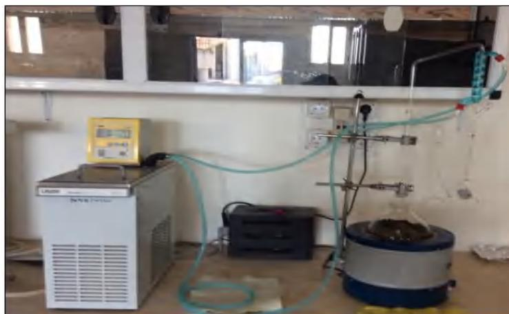
**Figure II-2:** Montage d'extraction des huiles essentielles par hydrodistillation (Clevenger).
