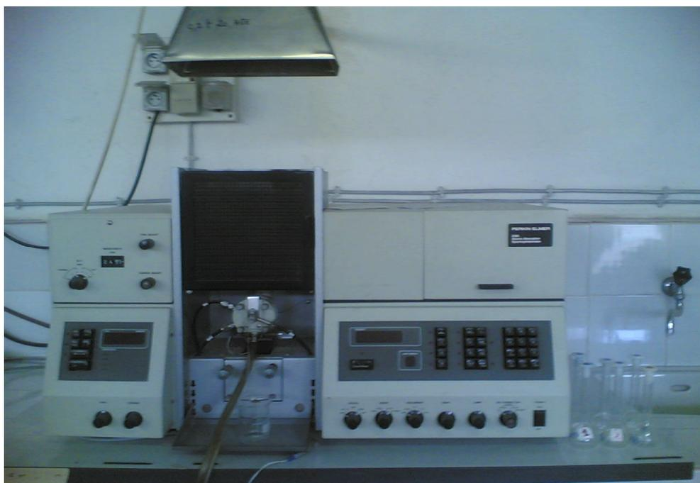
Figure 3: Spectrophotomètre d'absorption atomique Perkin Elmer 2380.
