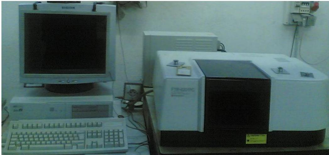
Figure 5 : Spectromètre IR Shimadzu E.
