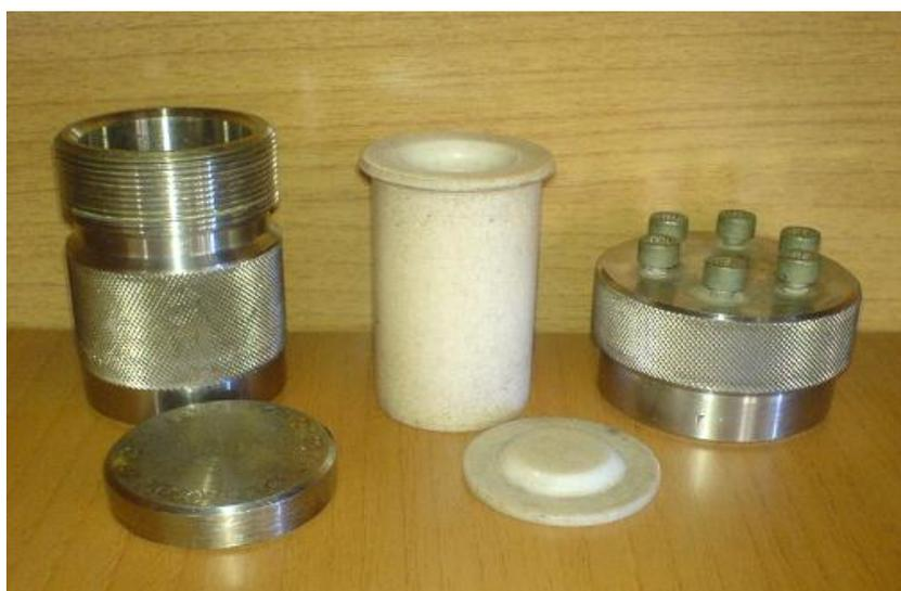
**Figure 03**- Autoclave locale de 23 ml de fabrication locale.
