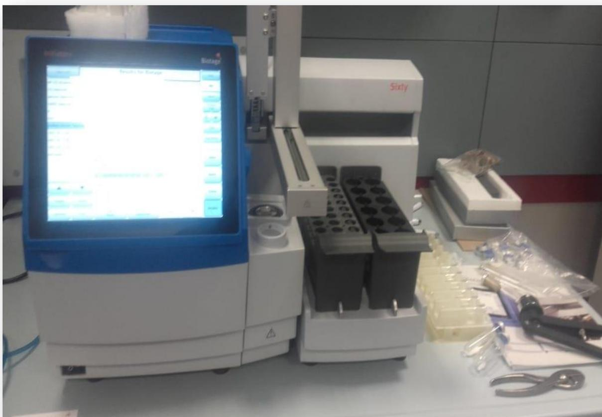
**Figure II.8 :** Extracteur Biotage Initiator TM 2.0 automatique.
