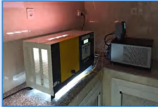
Figure II-6: Appareil SUNTEST CPS+ Atlas.
