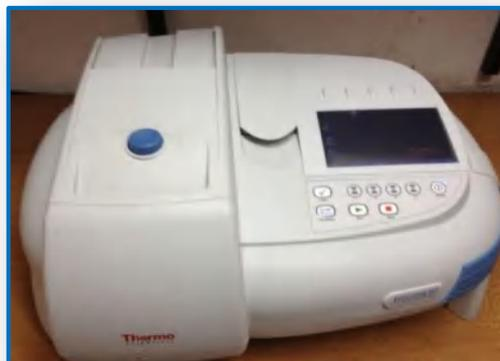
Figure II-11: Spectrophotomètre UV-vis «Thermo scientific».
