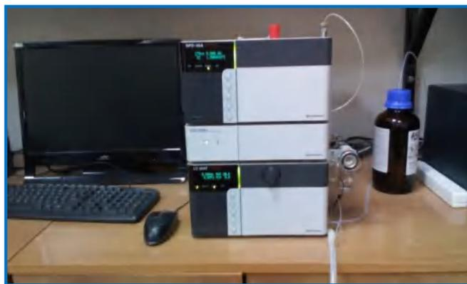
Figure II-12: Chromatographie liquide à haute performance Shimadzu LC20.
