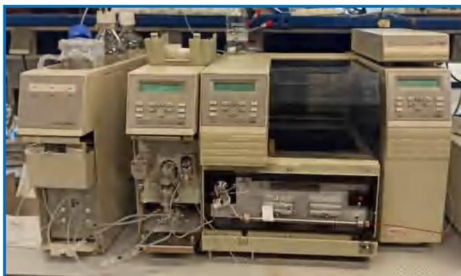
Figure II-13: Chromatographie liquide à haute performance Shimadzu LC20
