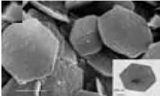
**Figure 18:** Photo MEB de l'HDL Mg-Al synthétisé par la méthode urée (Vial, 2005)
