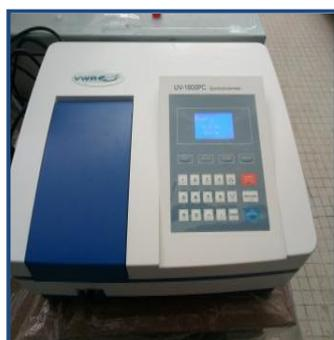
Spectrophotomètre UV visible
