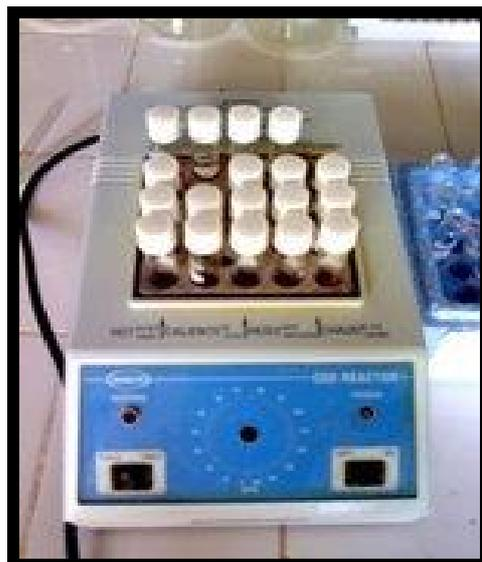
*Figure 26 : photographie d'un réacteur DCO*
