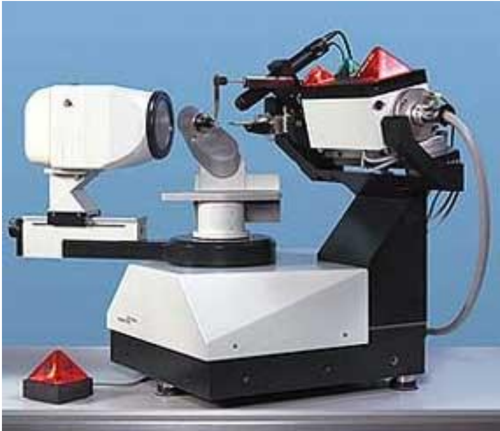
Figure 4 : Diffractomètre automatique à quatre cercle kappa CCD de Bruker-nonius.
