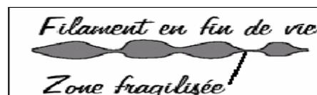
Le tungstène a une tendance à se redéposer en un point différent de celui d'où il vient. Il apparaît donc une série de points fragiles sur le filament, ces points sont autant de zones de rupture potentielles. Plus ces zones sont fragilisées, plus leur résistance électrique est importante, plus elles sont chaudes et moins elles sont aptes à recevoir le dépôt de tungstène. La fragilisation est donc accélérée en fin de vie du filament.
