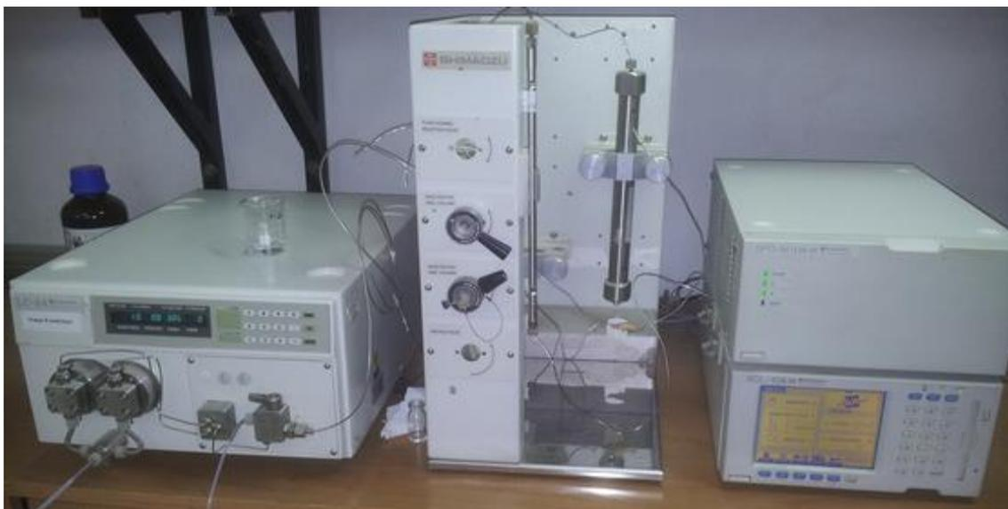
**Figure II.11:** Chromatographie CLHP Shimadzu du laboratoire LSTE.
