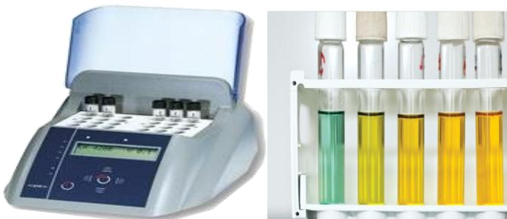
**Figure II.17:** Réacteur de type DCO –HANNA C 9800 pour la combustion des échantillons à 480°C.
