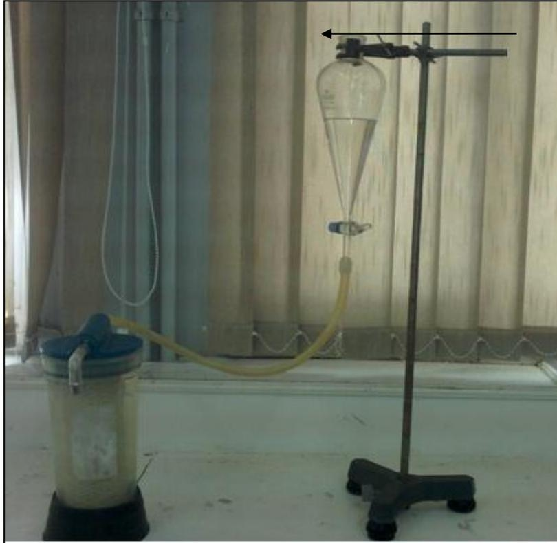
**Figure VI-5 :** Appareil de filtration
