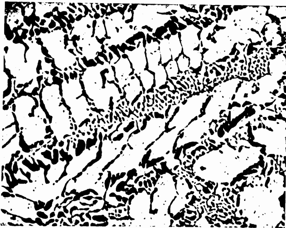
Figure 27 - \text{AuTe}_2 - \text{SnTe} (G \times 240). Attaque \text{HNO}_3 , 1/2 - 5 s.
