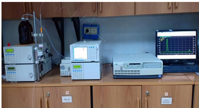
*Figure II.3. Chromatographie liquide à haute performance Shimadzu LC-10AT.*
