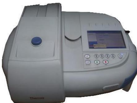
*Figure II.2. Spectrophotomètre UV-visible «Thermo scientific».*
