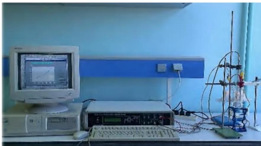
**Figure II.6** Dispositif de mesure utilisé pour les courbes de polarisation.
