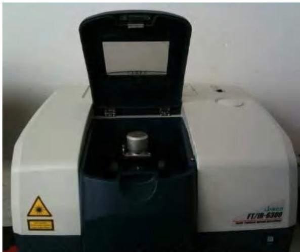
**Figure II-3** : Spectrophotomètre IR JASCO 6300
