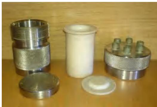
**Figure II-4 :** *Autoclave utilisé au laboratoire pour les synthèses hydrothermales.*
