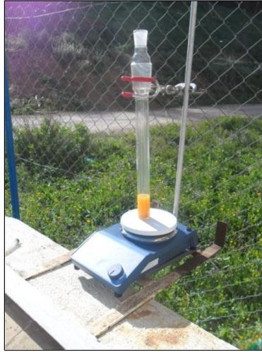
**Figure II.6 :** Montage expérimental du système d'irradiation solaire
