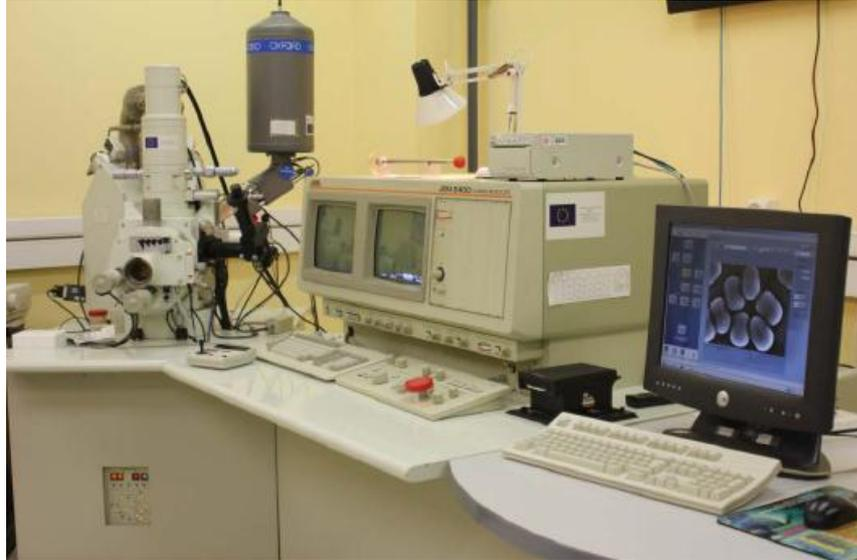
**Figure II.13** : microscope électronique à balayage JEOL JSM 6400
