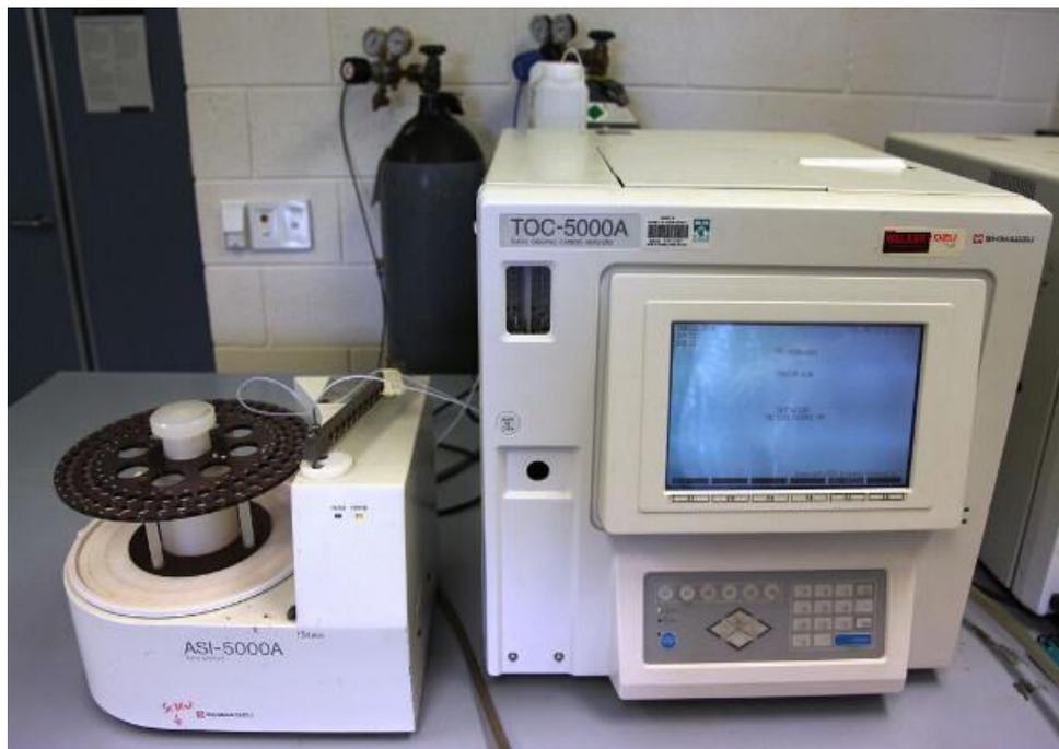
**Figure II.11** : Analyseur de carbone TOC-5000A Shimadzu
