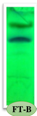
Figure IV.33 : Profil chromatographique de l'extrait FT-B dans le système CHCl 3 /MeOH (6:2)
