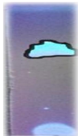
Figure IV.41 : Plaque CCM analytique du produit F11 dans le système CHCl 3 /MeOH (8:2)
