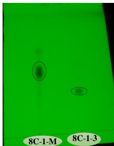
Figure IV.14 : Plaques CCM analytiques du mélange F4D-8C-1-M et le produit P1 dans le système CH 2 Cl 2 /acétone (9,8:0,2)
