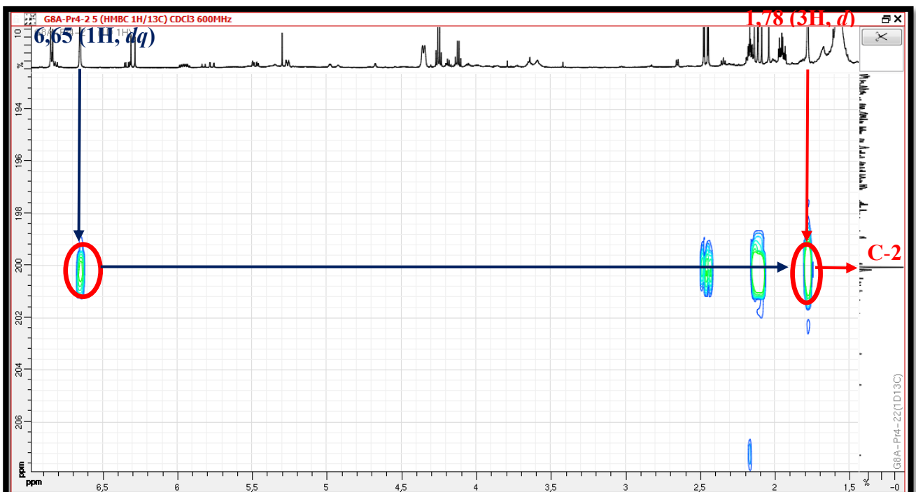
Spectre V.20.3 : Spectre HMBC étalé (600 MHz, CDCl 3 , \delta ppm) du composé P5
