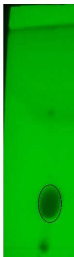
Figure IV.19 : Profil chromatographique de la sous-fraction F3B-6 dans le système hexane/AcOEt (9:1)
