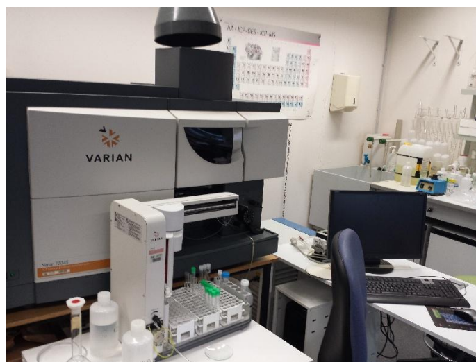
Figure IV.22 : Appareil ICP/AES de L'Institut Pluridisciplinaire Hubert Curien (IPHC), Strasbourg
