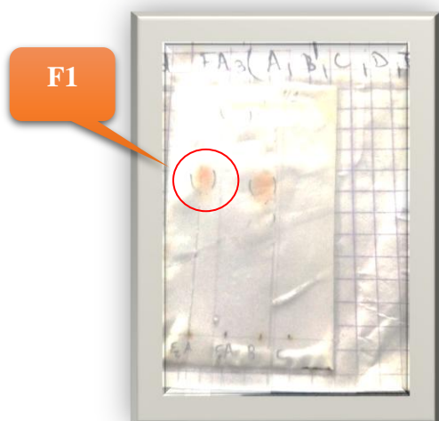
Figure IV.29 : Plaque CCM analytique du produit F1 dans le système hexane/AcOEt (5:5)
