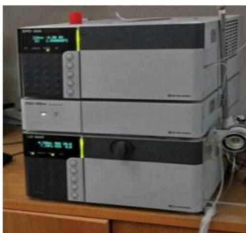
Figure II.2: HPLC Shimadzu LC 20.
