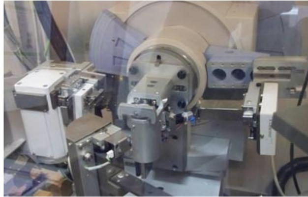
**Figure II.13 :** Diffractomètre PANalytical X'Pert Pro Philips.
