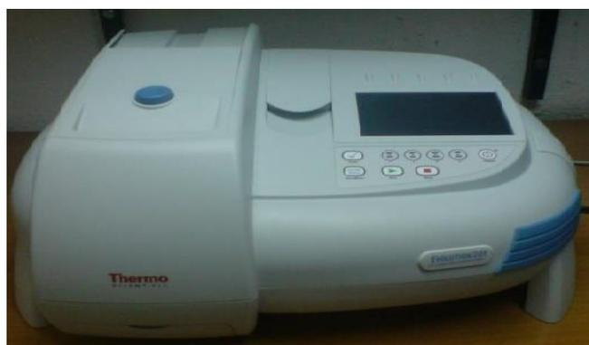
**Figure II.3 :** Spectrophotomètre UV/Visible type Thermo Fischer Evolution 201.
