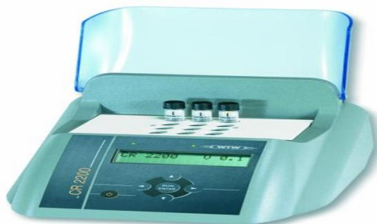
**Figure II.11** : bloc chauffant utilisé pour la DCO (CR2200).
