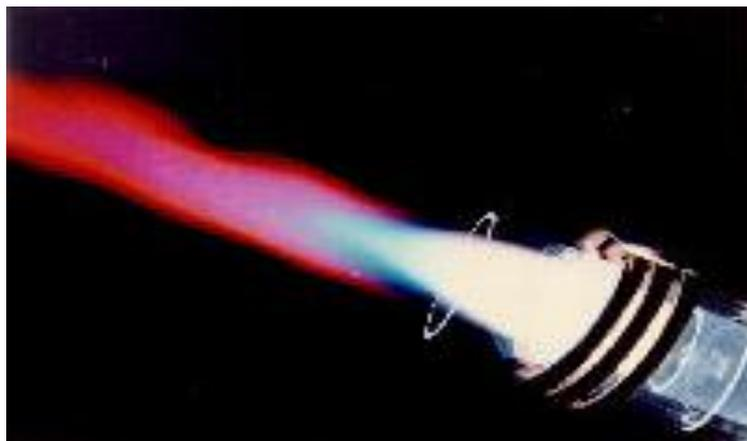
**Figure 6.** Bobine d'induction dans un ICP.
