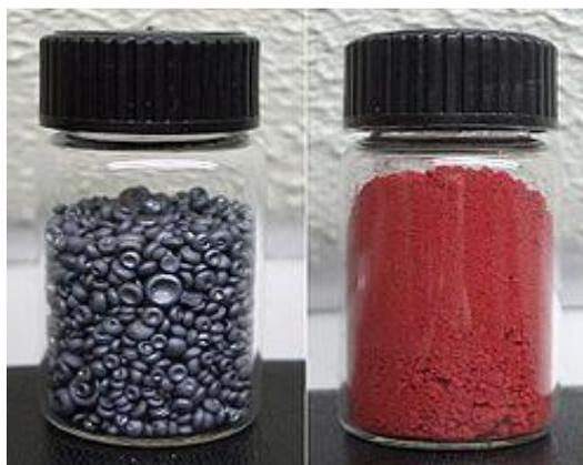
**Figure 2.** Image des deux allotropes de sélénium gris et rouge.
