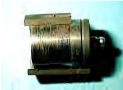
**Figure I-10 : Corrosion frottement d'une pièce en acier**
