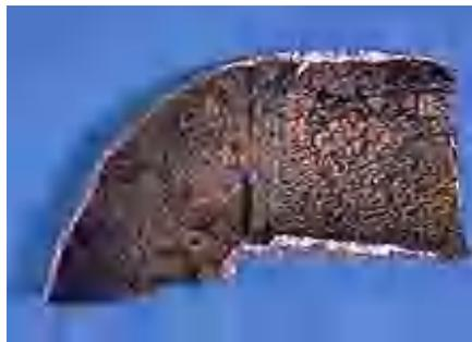
**Figure I-8: Corrosion-érosion d'un tube en cuivre véhiculant de l'eau**
