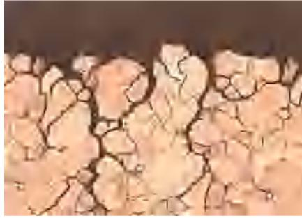
**Figure I-9: Corrosion sous contraintes d'un alliage cuivreux**
