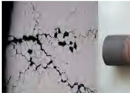
**Figure I-6: Corrosion inter-granulaire d'un acier inoxydable**
