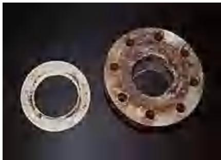
**Figure I-4: Corrosion par crevasse d'un acier allié sous un joint**
