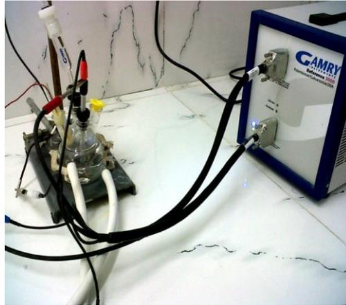
**Figure II.1** Schéma du dispositif expérimental utilisé lors des mesures électrochimiques
