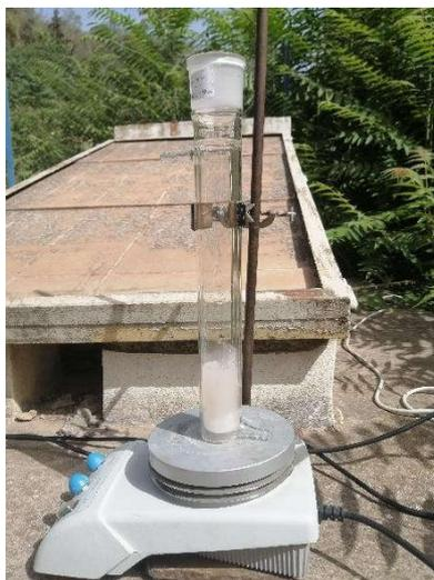
**Figure II.4** : Dispositif d'irradiation en lumière naturelle
