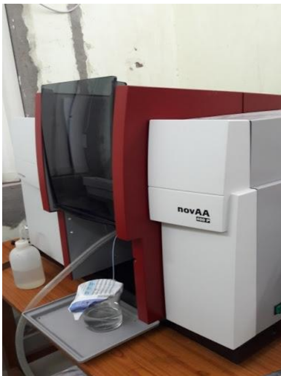
Figure I. 3. Spectroscopie d'absorption atomique à flamme; Analytik Jena NovAA 400
