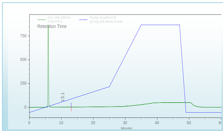
Figure III.7. Chromatogramme CLHP analytique en phase inverse du composé P6.
